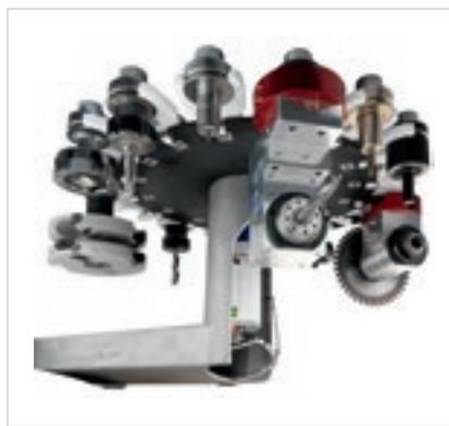
Revolvermagazin mit 12 Positionen am Kopf und 16 Positionen am Schlitten X.
