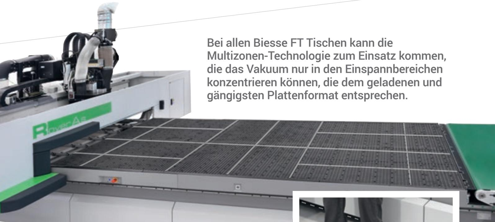
Bei allen Biesse FT Tischen kann die Multizonen-Technologie zum Einsatz kommen, die das Vakuum nur in den Einspannbereichen konzentrieren können, die dem geladenen und gängigsten Plattenformat entsprechen.
