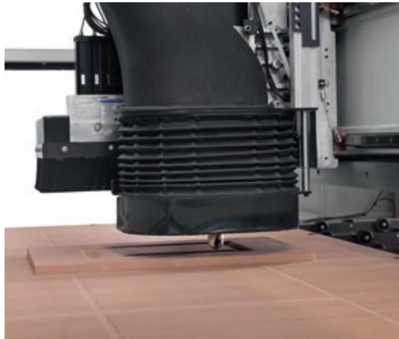
Saughaube mit 12 programmierbaren Positionen und Verwendung einer unterbrechungsfreien Verkleidung für maximale Saugkapazität.
